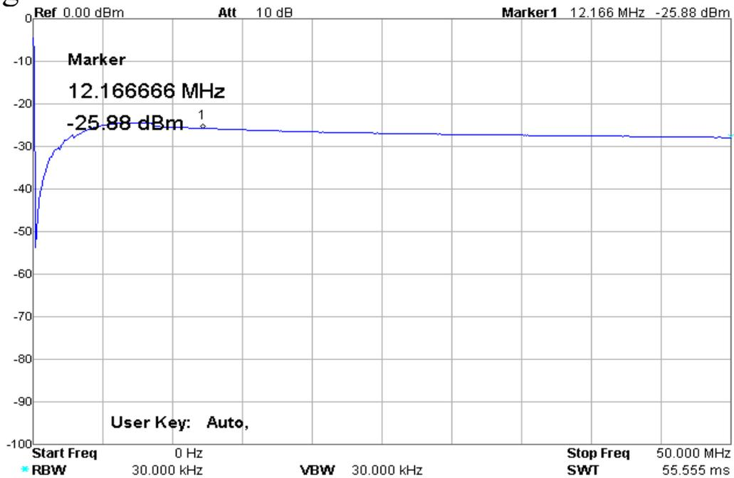
Dazu wurden -36 dBm eingespeist. Die Gain ist also gut +10 dB. Allerdings wurden auch die Windungszahlen etwas höher ausgelegt als bei der Simulation.
